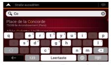
**Grund**: Fiat Doblò AVN verfügt über eine intelligente Tastatur für die Adresssuche. Das bedeutet, dass nur diejenigen Tasten aktiv geschaltet sind, die zur Eingabe eines Namens verwendet werden können, der auf der Karte angezeigt wird.
