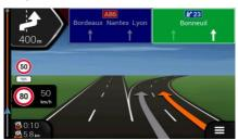
**Grund**: Wenn Sie sich einer Autobahnausfahrt oder einer komplizierten Kreuzung nähern und entsprechende Informationen verfügbar sind, wird die Karte durch eine 3D-Ansicht der Kreuzung ersetzt. Die Spuren, auf denen Sie sich einordnen müssen, werden mit Pfeilen gekennzeichnet.
